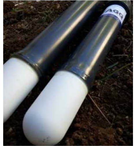
Particolare della Sonda Lisimetrica brevettata da AGQ. Da notare la capsula in porcellana porosa che permette alla sonda di intercettare la soluzione circolante che verrà analizzata successivamente in laboratorio
