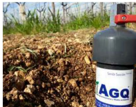
Particolare della Sonda Lisimetrica brevettata da AGQ, in una installazione (punto di controllo) in un vigneto dell'arco jonico
