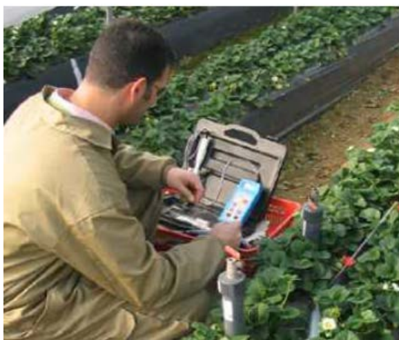
Agronomo Agq durante le operazioni di estrazione delle soluzioni circolanti dalle sonde
